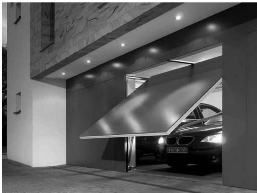
Рисунок 1.3 – Подъемно-поворотные ворота гаража
